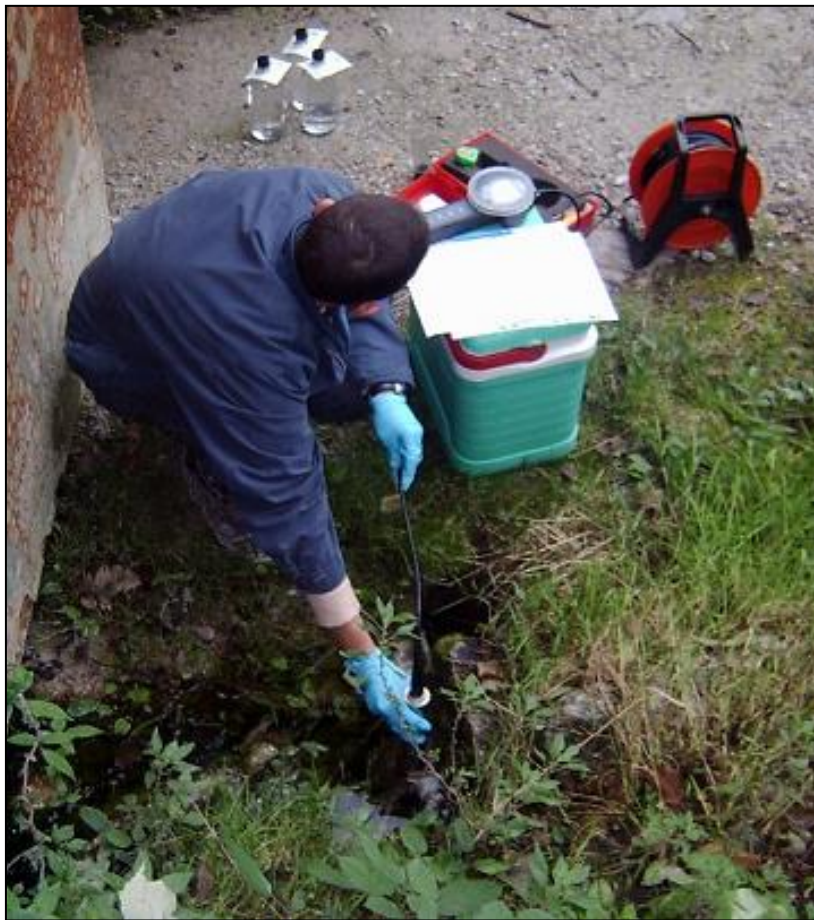
Figura 4-5 Prelievi di acque da un piezometro
