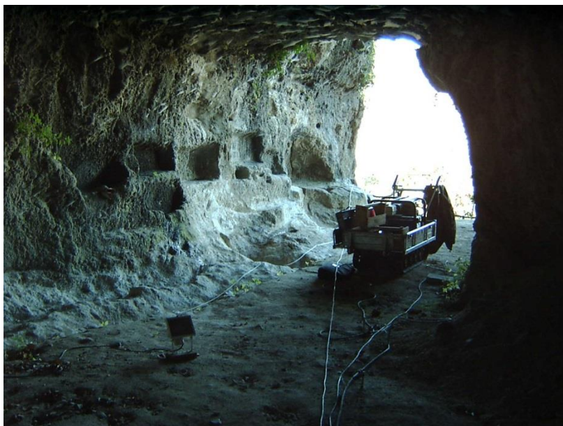
Figura 2-18 Prospezioni geoelettriche (tomografia) ingresso grotta Re Tiberio
