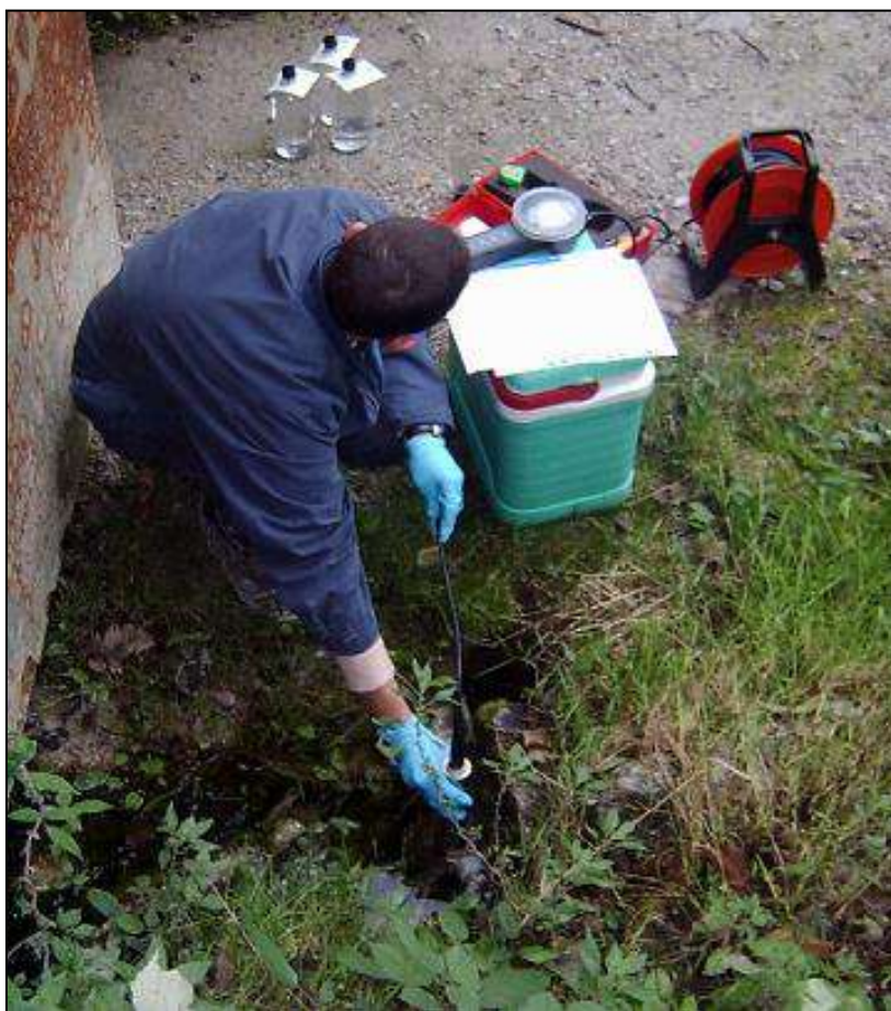
Foto 9 : Prelievi di acque da un piezometro
