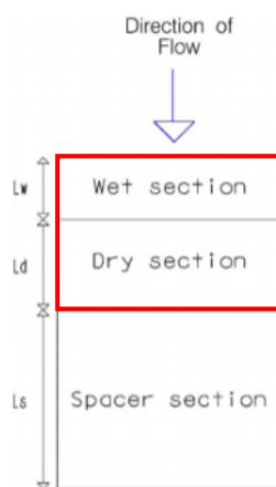
Figura 8.9: Modulo tipo, descrivente il modello concettuale idrologico dell’installazione di strutture fotovoltaiche a tracker su pali infissi comprendente l’area pannelli (in rosso) e l’area di interfila (Fonte: Hydrologic response of solar farm Cook 2013 American Society of Civil Engineers).
