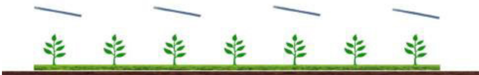
Figura 8: Sistema agrivoltaico in cui la coltivazione avviene tra le file dei moduli fotovoltaici, e sotto a essi (TIPO 1).
