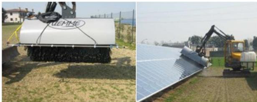
Figura 12: Dispositivi di pulizia moduli - Pulizia dei moduli
