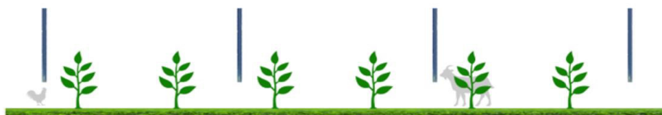
Figura 10: Sistema agrivoltaico in cui i moduli fotovoltaici sono disposti verticalmente. La coltivazione avviene tra le file dei moduli fotovoltaici, l'altezza minima dei moduli da terra influenza il possibile passaggio di animali (TIPO 3).
