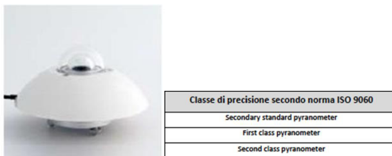
Figura 6: Piranometro e classi di precisione
