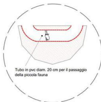
Figura 165: Esempio di realizzazione tubazioni in PVC per passaggio piccola fauna
