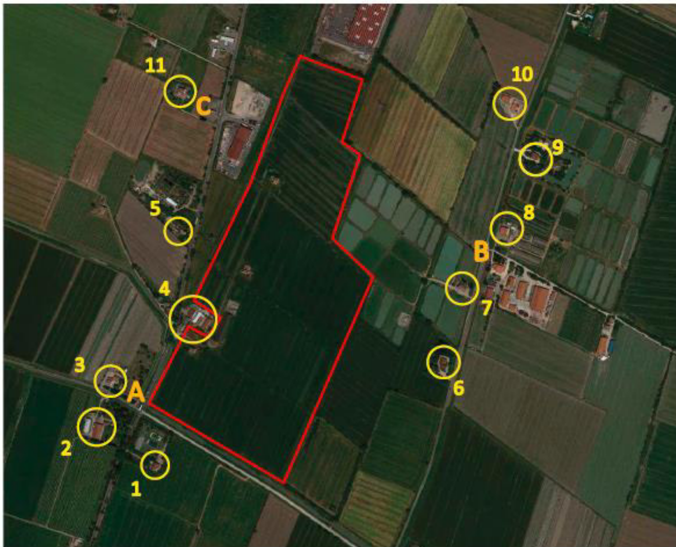
Figura 3: Punti di misura del rumore residuo
