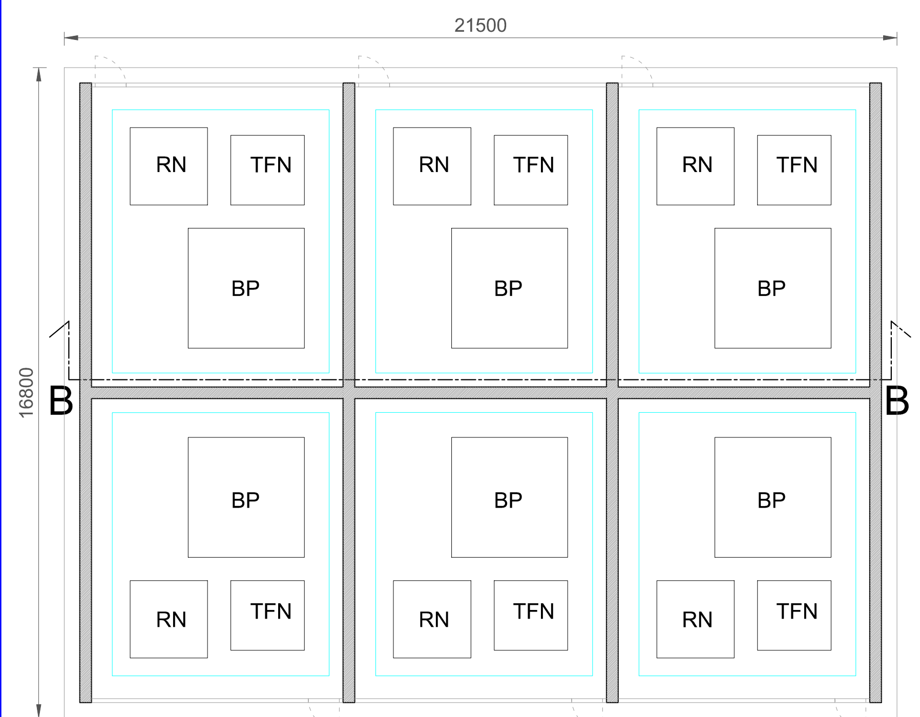
Pianta Bobine Petersen, Trasformatore Formatore di neutro, Resistenza di neutro
