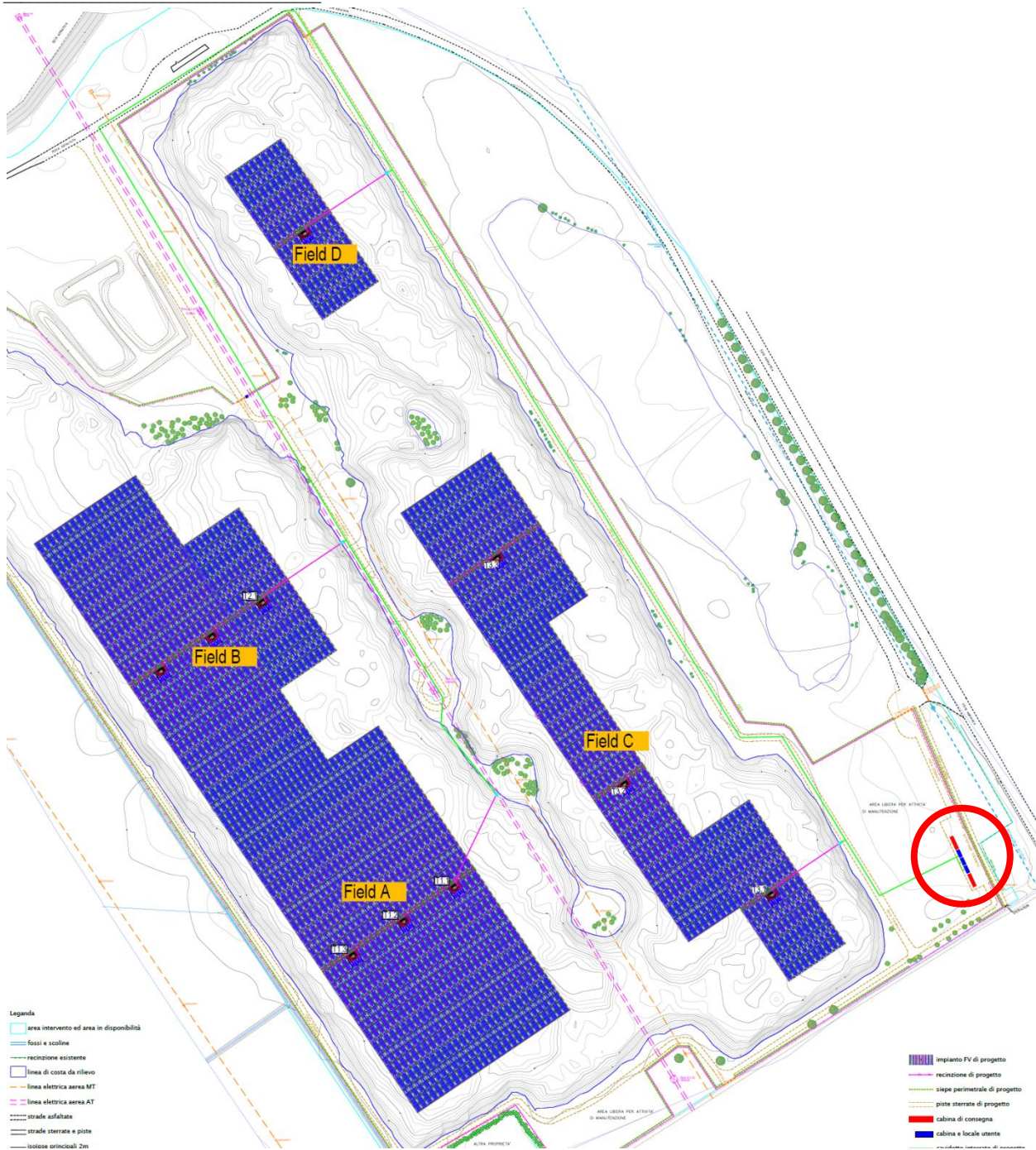
Fig. 46 – layout progettuale. Il cerchio rosso sulla destra in figura indica la zona nella quale saranno posizionate le cabine di consegna punto da quale parte la linea di connessione con cavo interrato alla CP Cervia.
