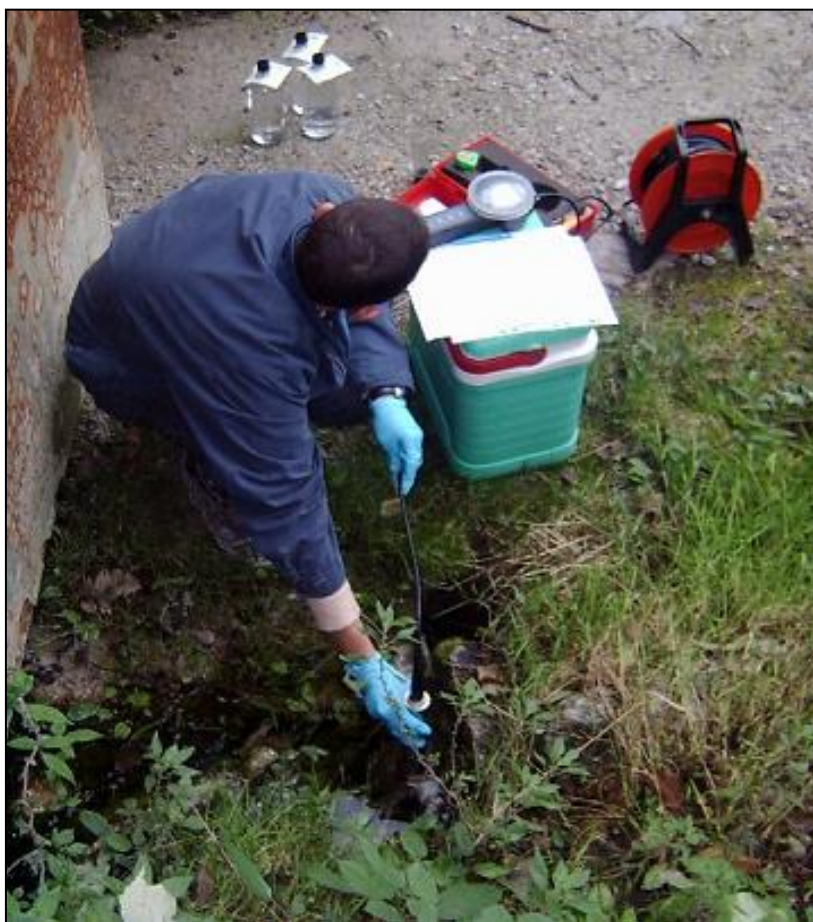
Foto 9 : Prelievi di acque da un piezometro
