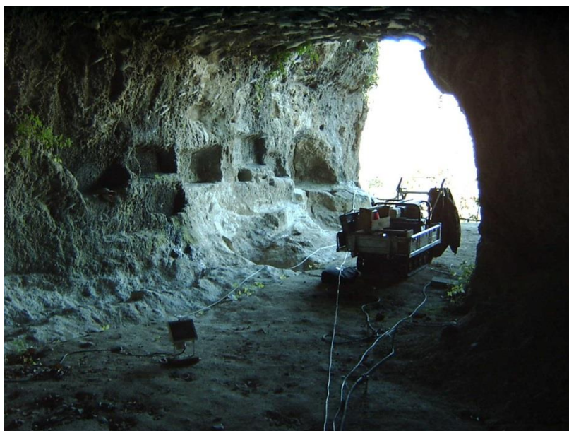
Foto 5: Prospezioni geoelettriche (tomografia) ingresso grotta Re Tiberio
