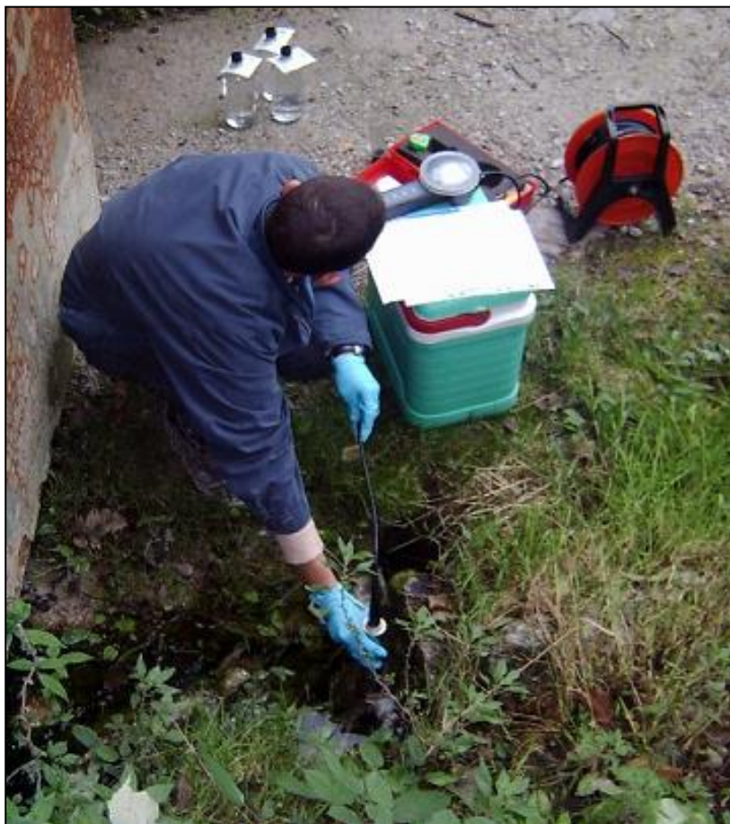
Foto 8 : Prelievi di acque da un piezometro
