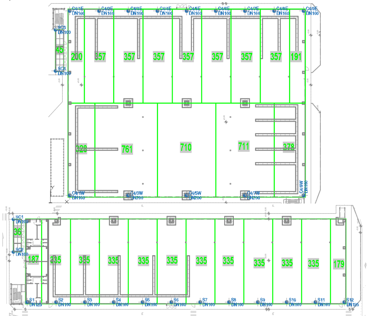
Figura 5 - Indicazione dei pluviali e delle aree afferenti per l'edificio C4.A e C4.B
