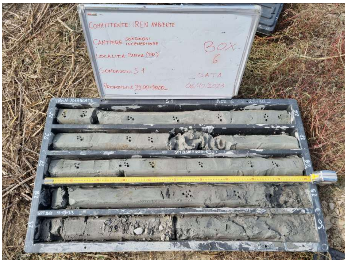
RAPPRESENTAZIONE FOTOGRAFICA -Sondaggi Inceneritore CASSETTE CATALOGATRICI 20.00-25.00 E 25.00-30.00 m
