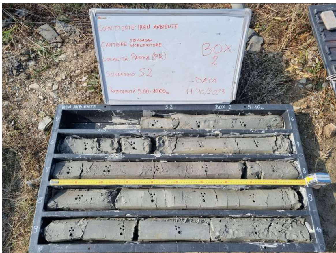
RAPPRESENTAZIONE FOTOGRAFICA - Sondaggi Inceneritore CASSETTE CATALOGATRICI 0.00-5.00 E 5.00-10.00 m
