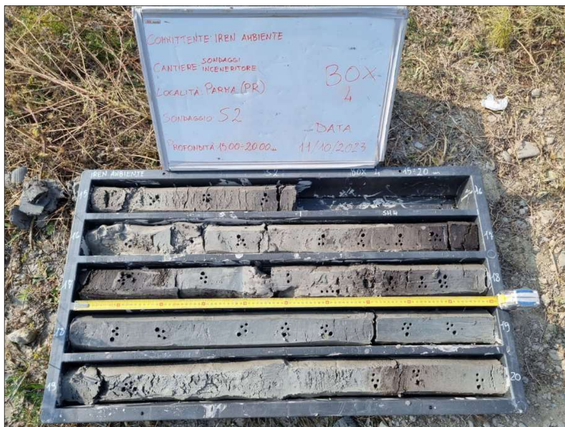
RAPPRESENTAZIONE FOTOGRAFICA - Sondaggi Inceneritore CASSETTE CATALOGATRICI 10.00-15.00 E 15.00-20.00 m
