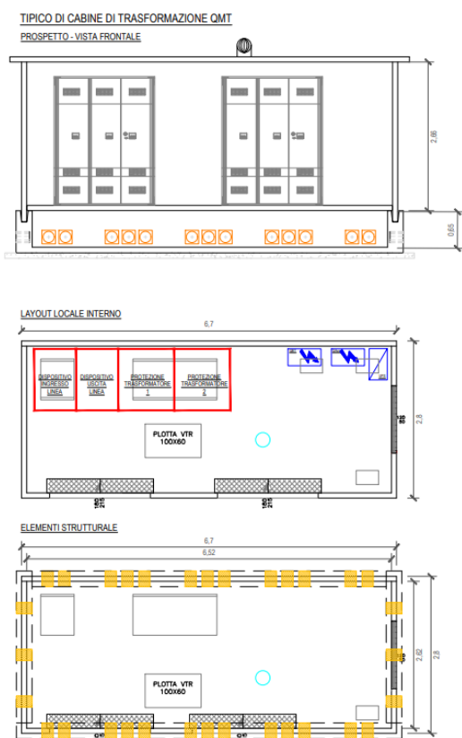
CABINA DI TRASFORMAZIONE Scala di Riproduzione 1:50
