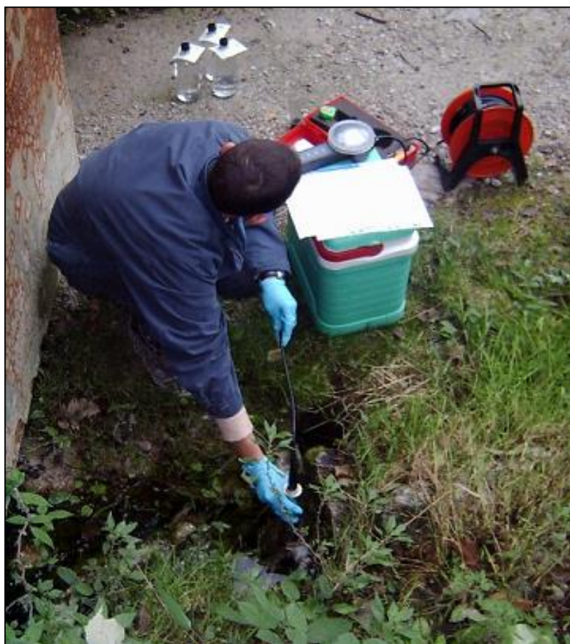
Foto 9 : Prelievi di acque da un piezometro
