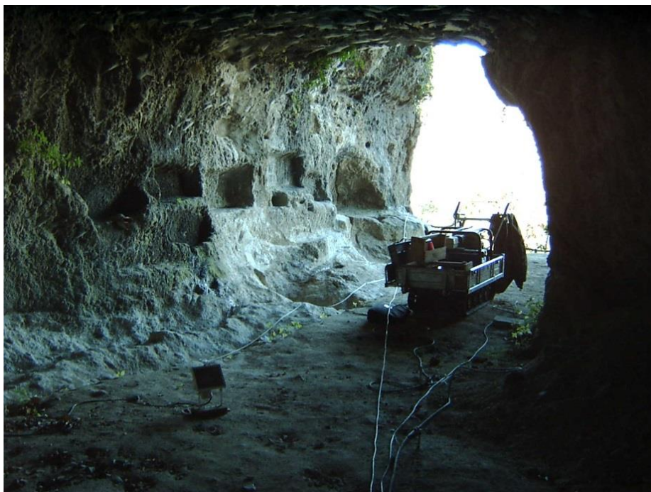
Foto 5: Prospezioni geoelettriche (tomografia) ingresso grotta Re Tiberio
