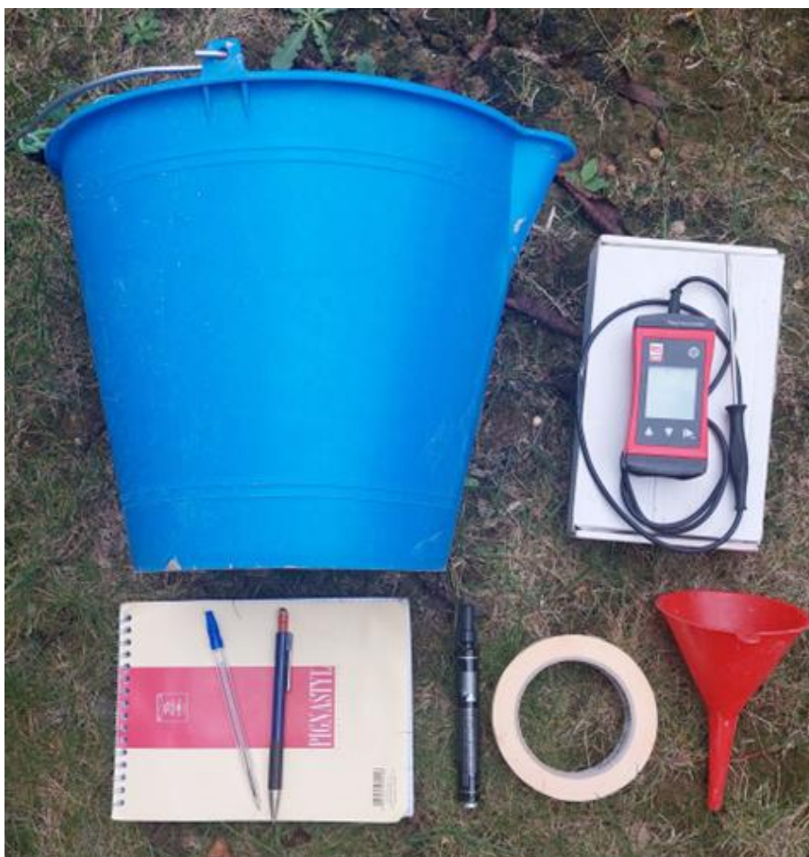
Figura 3-1: strumentazioni e materiali impiegati per il campionamento delle acque superficiali.
