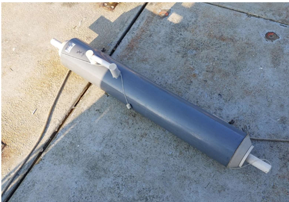
Figura 2-4 Campionatore di tipo Niskin utilizzato per il campionamento acque
