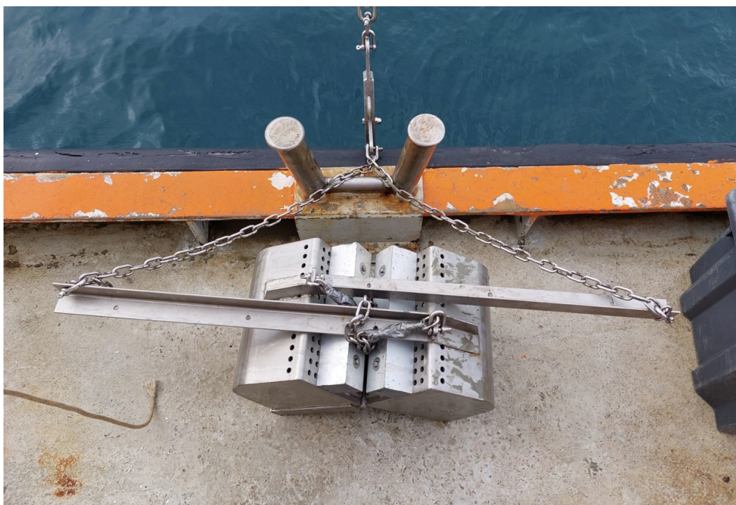
Figura 2-3 Benna Van Veen utilizzata per il campionamento
