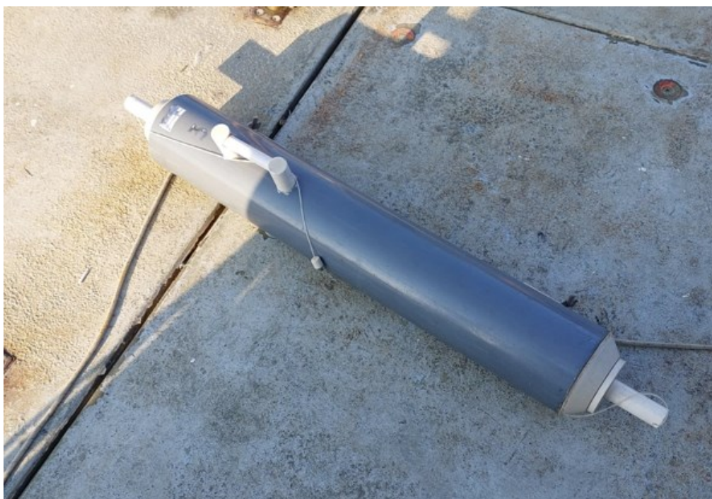
Figura 2-5 Campionatore di tipo Niskin utilizzato per il campionamento acque
