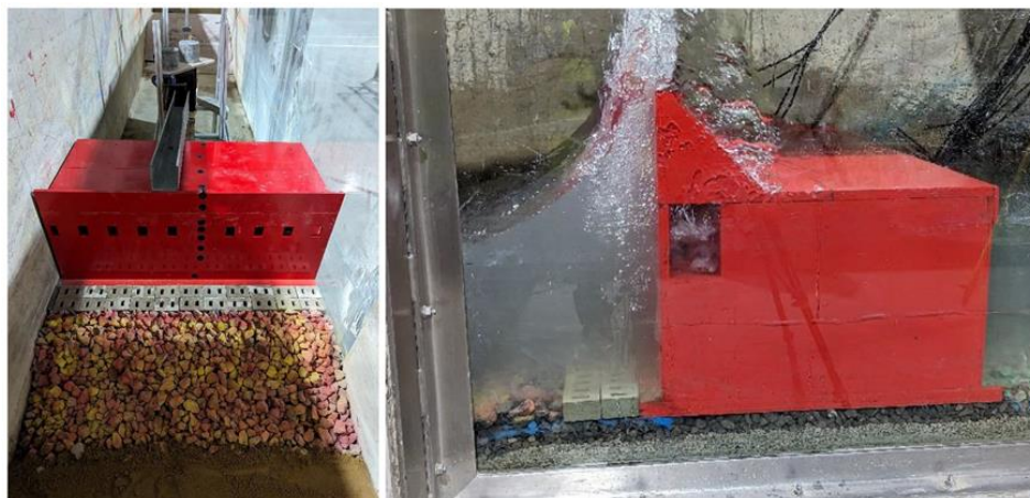
Figura 3-2. Modello del cassone sperimentale
