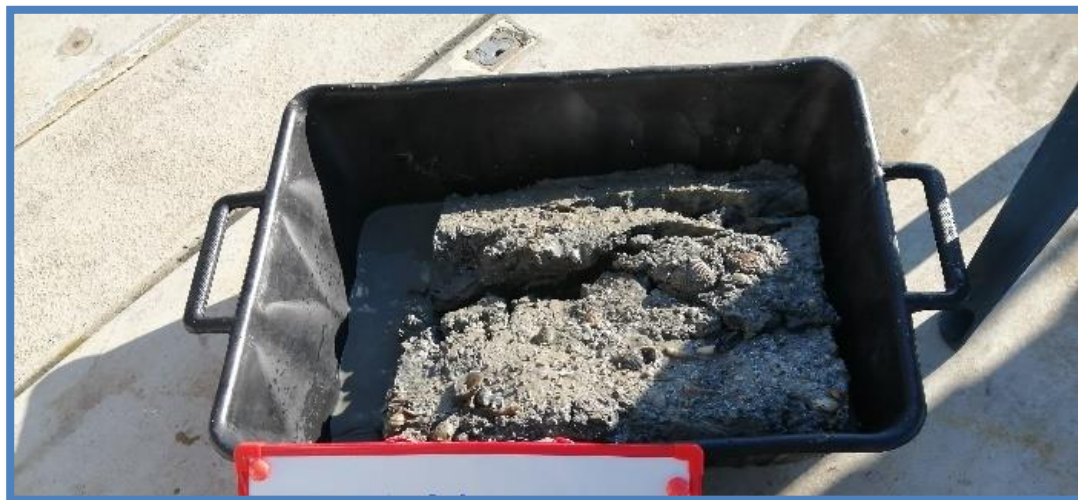
Figura 3. Esempio di campione raccolto con bennata
