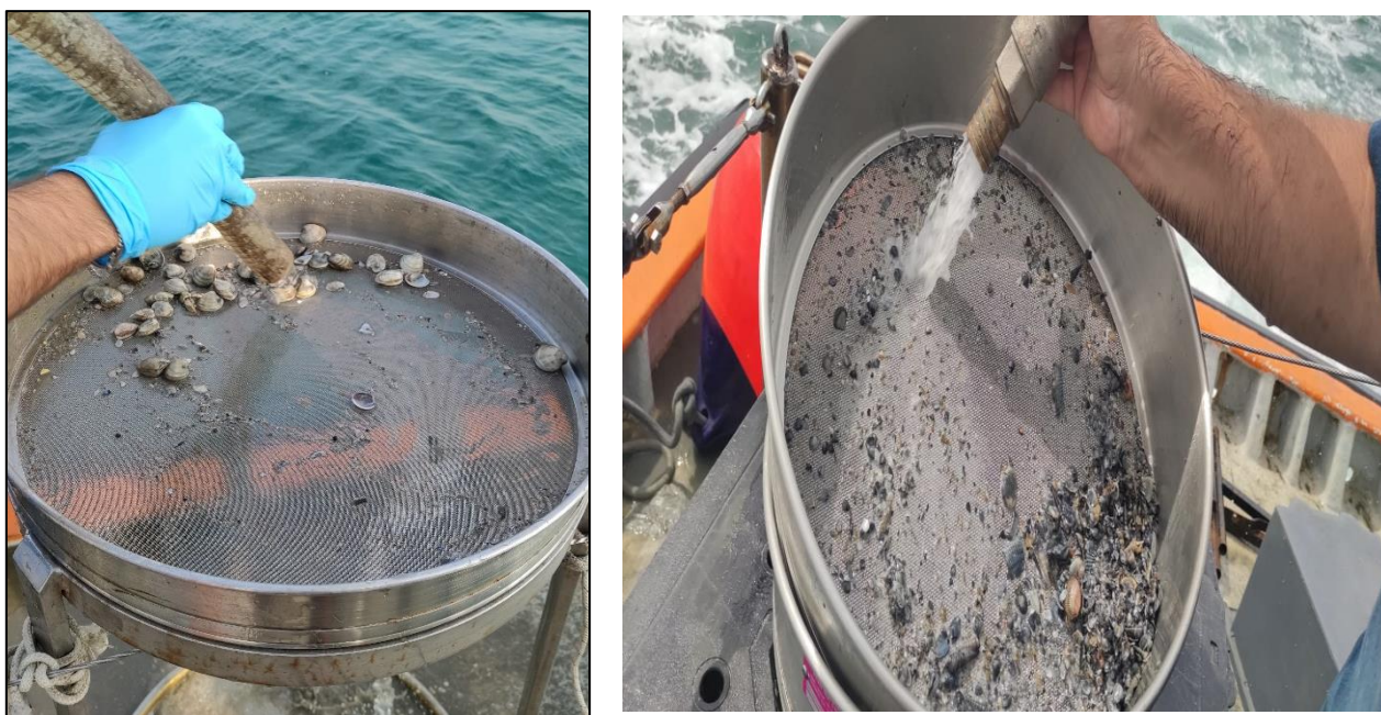
Figura 19. Setacciatura dei sedimenti per la determinazione del macrozoobenthos
