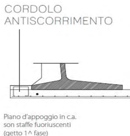
Figura n° 2: Particolare posa elemento autostabile
