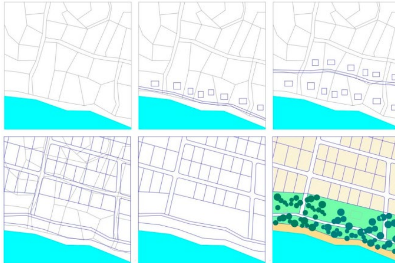
Figura 8. Rappresentazione schematica dell'applicazione della ricomposizione fondiaria per ottenere l'arretramento costiero (adattato secondo JICA)
