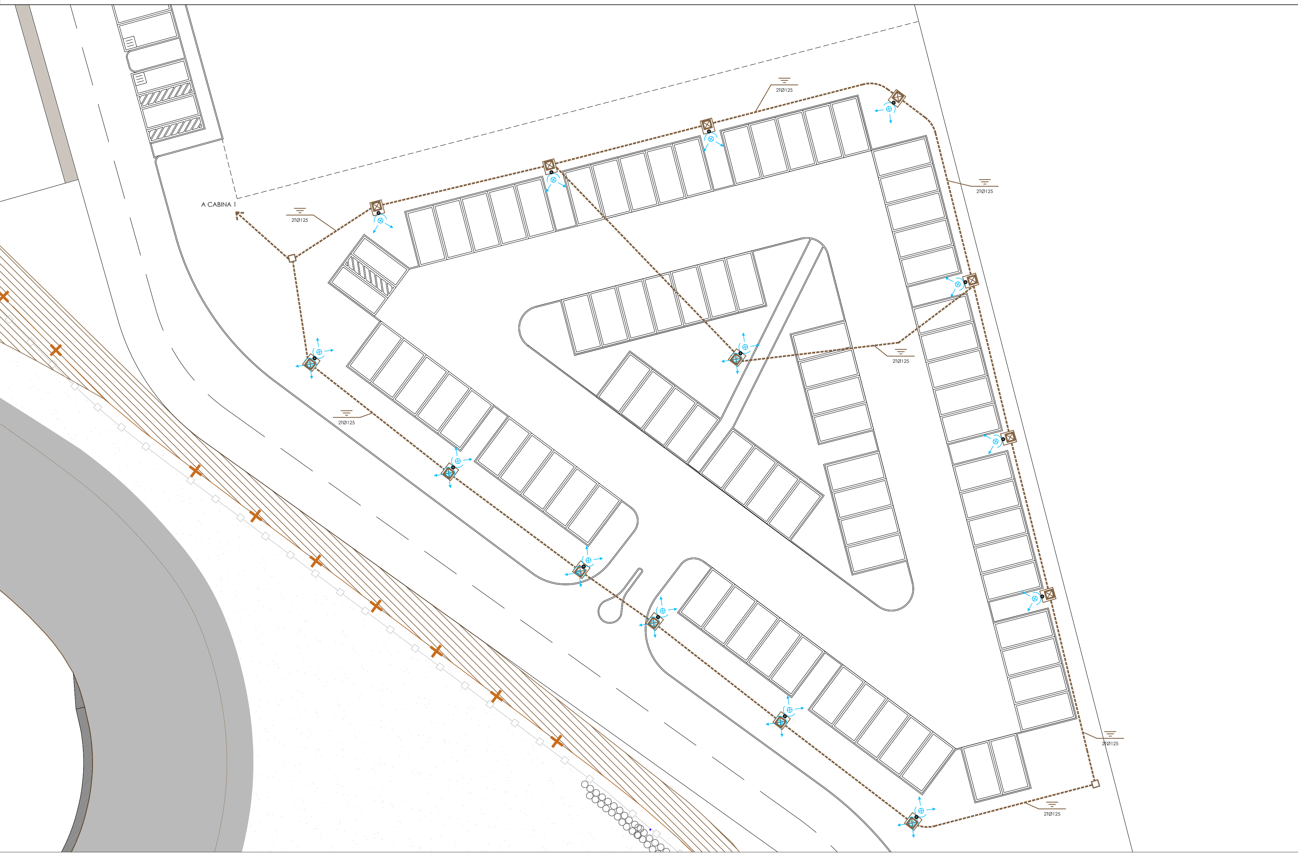
PARCHEGGIO "A" - PLANIMETRIA DISTRIBUZIONE ILLUMINAZIONE ESTERNA - SCALA 1:200
