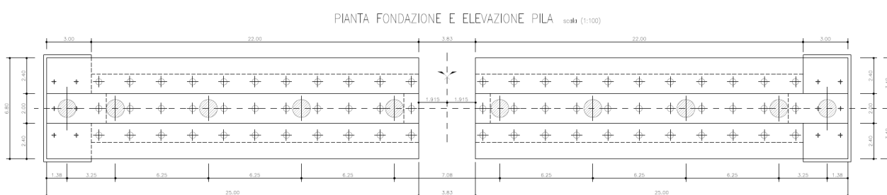
Figura 1.7: Pianta fondazione ed elevazione pila
