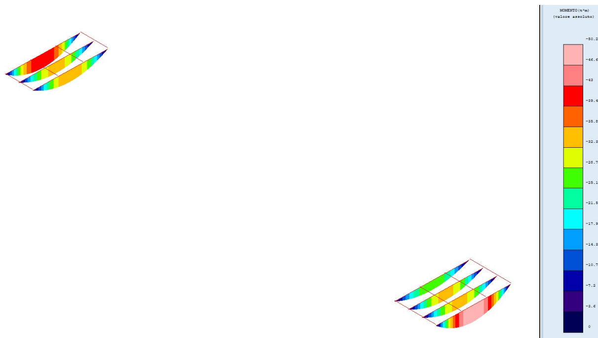
Figura 4-2. Involuppo M_x [tm]
