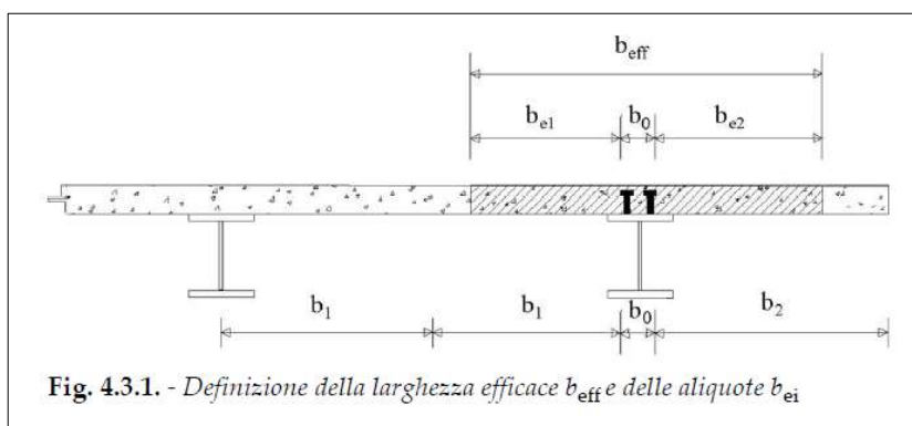
Figura 2-1. Definizione della larghezza efficace b_{eff} e delle aliquote b_{ei} (Fig.4.3.1 delle NTC2018)
