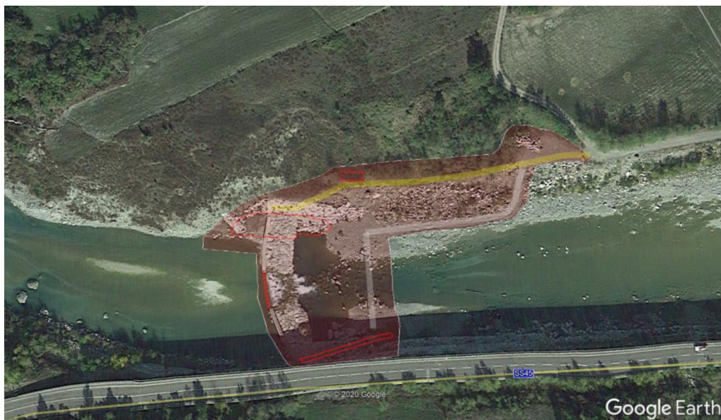
Figura 35 – Ortofoto con indicazione dell'area di cantiere complessiva prevista (rosso). La linea gialla rappresenta la pista di cantiere principale (che al termine dei lavori verrà convertita in pista di accesso definitiva); la linea bianca rappresenta una pista di cantiere secondaria, necessaria per le operazioni in alveo e per la realizzazione della scala per pesci.
