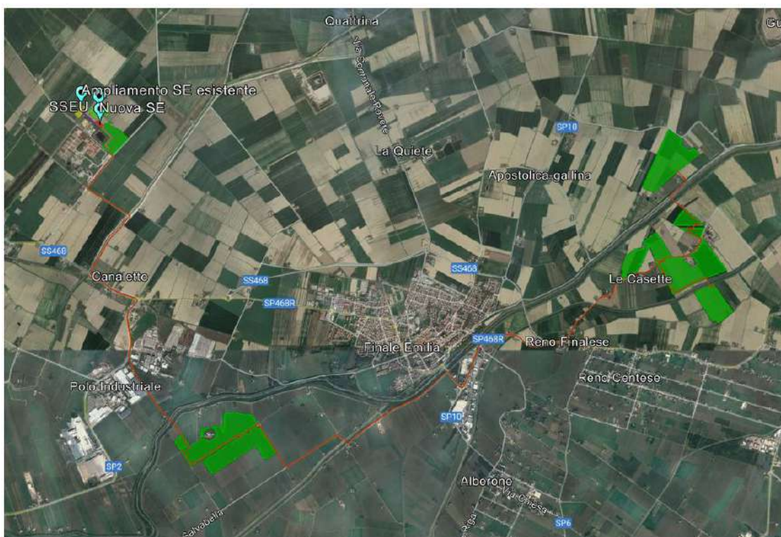
Figura 75 - Tracciato del cavidotto interno di collegamento e quello esterno verso la nuova SE
