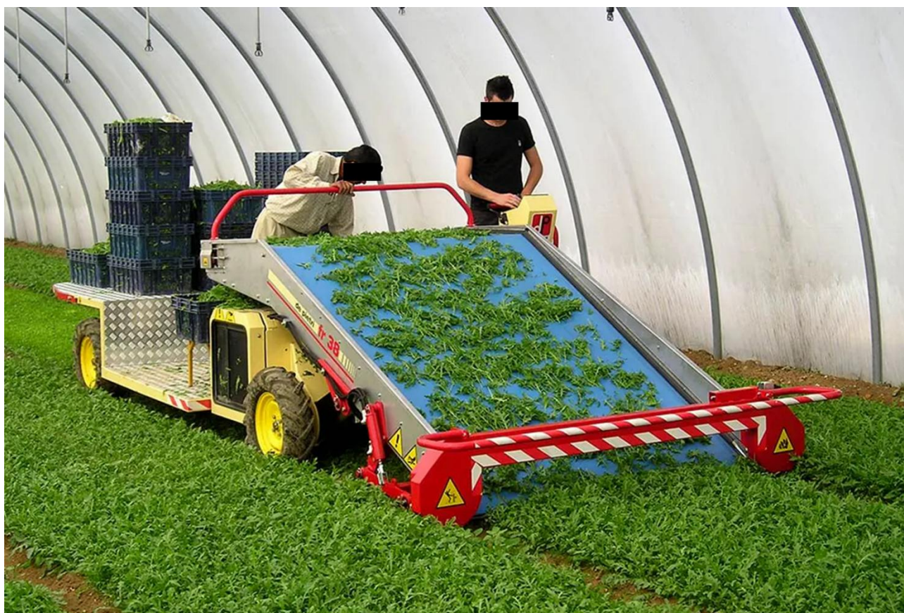
Figura 6-19-Macchina raccoglitrice per lo spinacio e Mizuna (non presente in azienda ma compatibile con l'interfila dell'impianto agrivoltaico)
