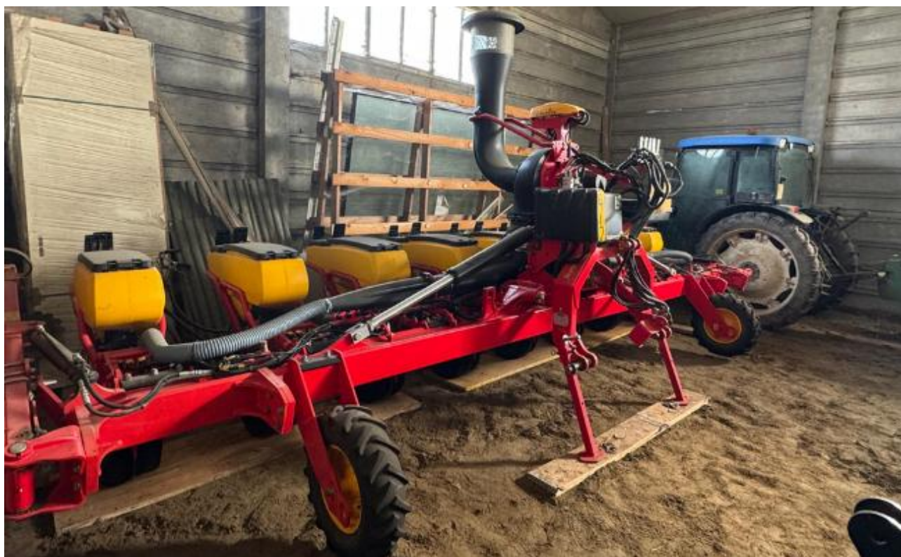
Figura 6-17-Seminatrice di precisione in possesso all'azienda
