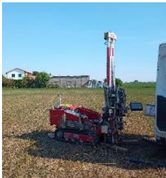
Figura 8-2 – Penetrometro TG63-200
