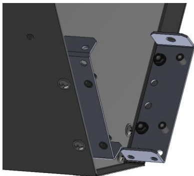
Installazione delle staffe all'interno della barriera
