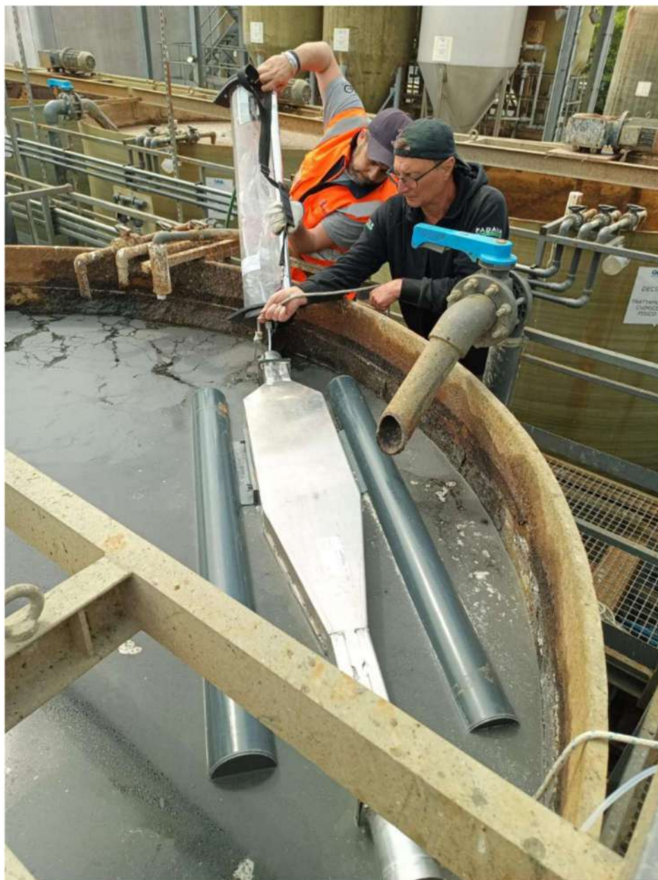
Figura 10. Fase di campionamento della sorgente VC.TN - Trattamento chimico-fisico
