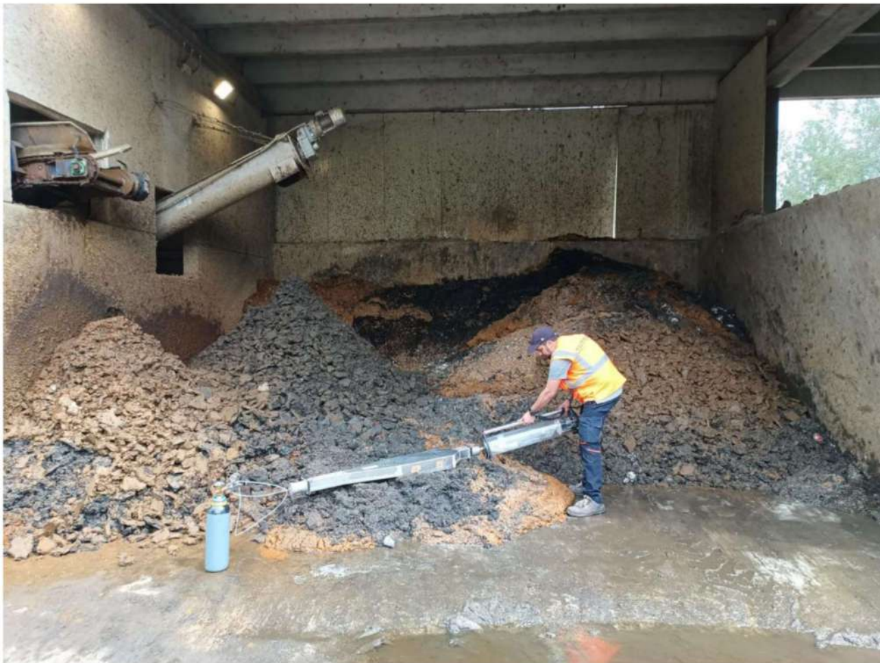
Figura 11. Fase di campionamento del deposito fanghi ED48
