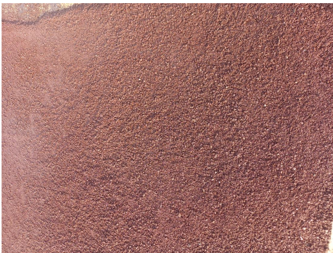
Figura 4 - Asfalto color ocra prima della compattazione
