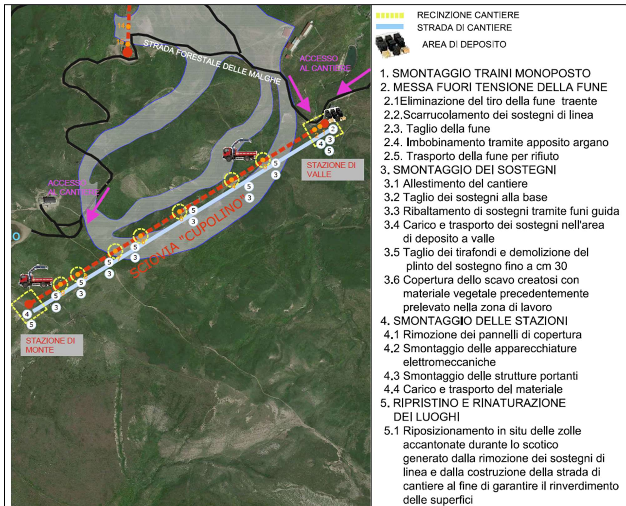
Figura 40 Cantierizzazione smontaggio sciovia "Cupolino"
