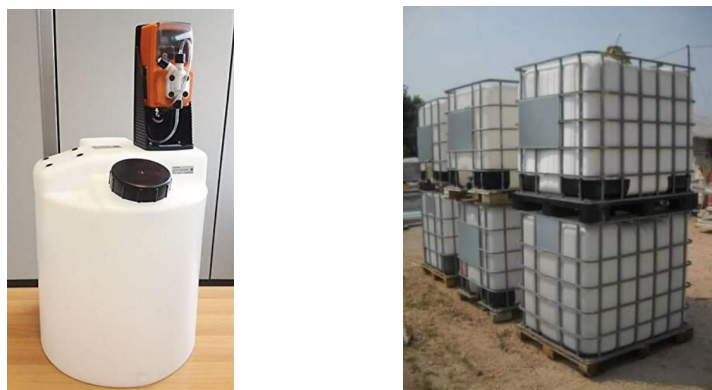
Figura 17 – Stoccaggio e dosaggio di prodotti chimici mediante “cubiloti”
