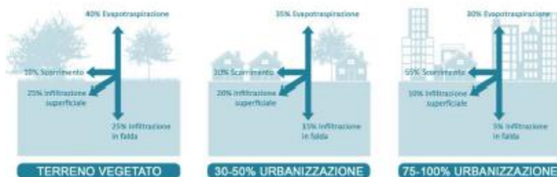
Figura 7: Impatto dell'impermeabilizzazione dovuta all'urbanizzazione sul ciclo idrologico dell'acqua. Fon-te: Gibelli G., 2015, GESTIONE SOSTENIBILE DELLE ACQUE URBANE. MANUALE DI DRENAGGIO 'URBANO'
