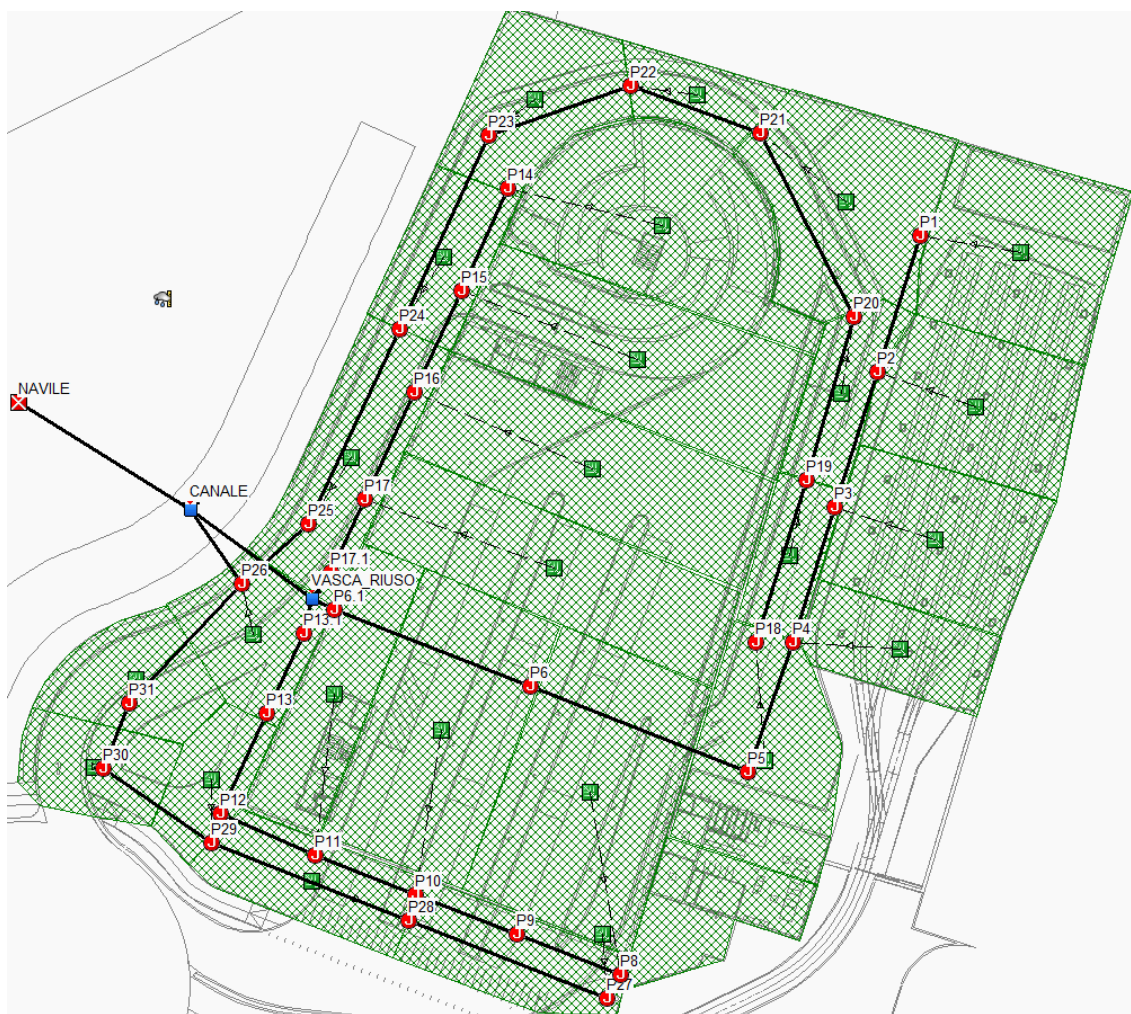
Figura 6: Schema del modello implementato su SWMM.
