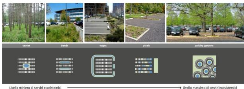
Figura 7. Diversi approcci SuDS per il drenaggio sostenibile delle acque di pioggia dai parcheggi. Fonte: Huber, J., 2010. Low Impact Development: a Design Manual for Urban Areas (riadattato)
