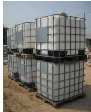
Figura 17 – Stoccaggio e dosaggio di prodotti chimici mediante “cubilotti”
