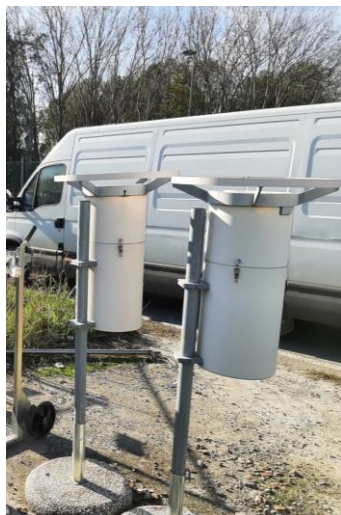
Figura 6 – Deposimetri bulk utilizzati per il campionamento della deposizione atmosferica
