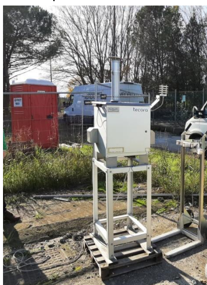
Figura 4 – Strumento Skypost per il campionamento del PM10
