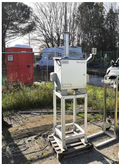
Figura 4 – Strumento Skypost per il campionamento del PM10
