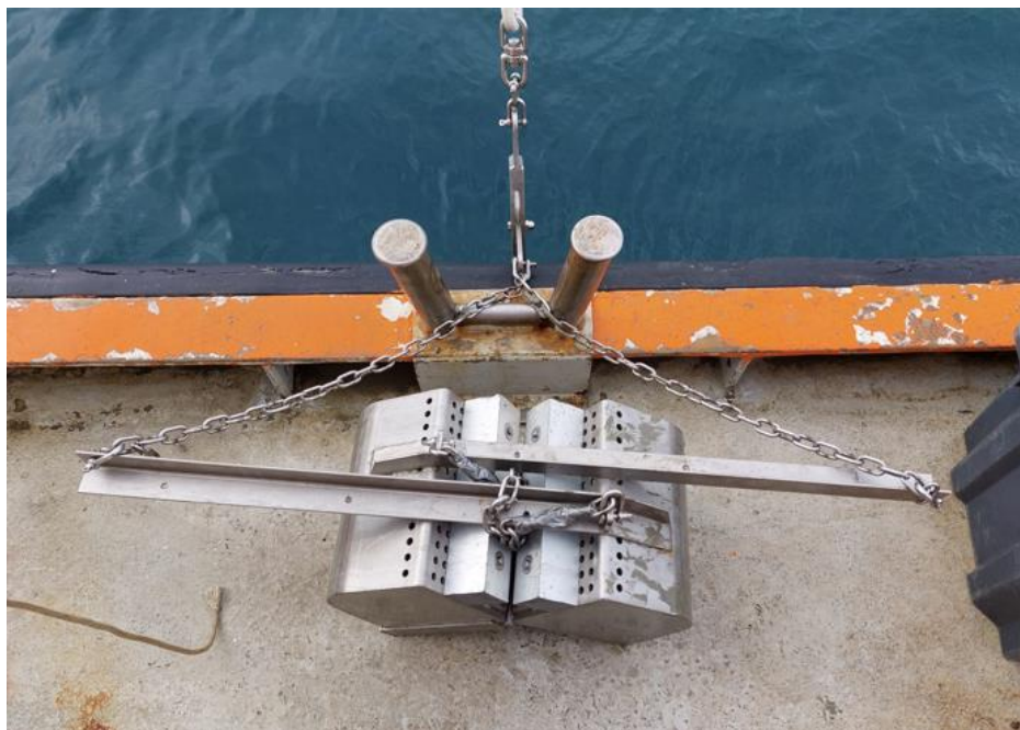
Figura 2-3 Attrezzatura per il prelievo campioni – Benna Van Veen
