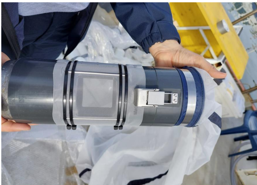
Figura 2-6 Contenitore per il campionamento dello zooplancton.
