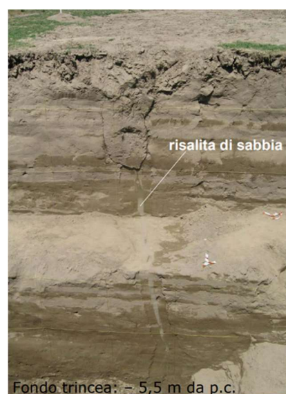
Figura 4-8: Foto fenomeno di liquefazione nell'area dell'alto ferrarese a seguito dei terremoti del 20 e 29 Maggio 2012
