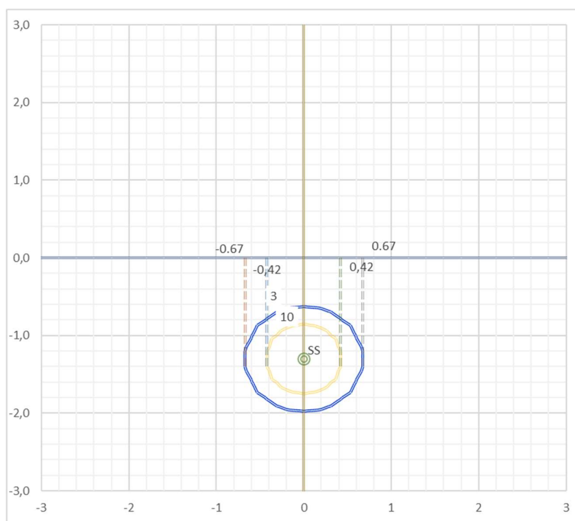
Figura 2: Curve di equilivello per il campo di induzione magnetica generato dalla linea MT in cavo da 240 mm 2 nel caso di n.1 terna per scavo
