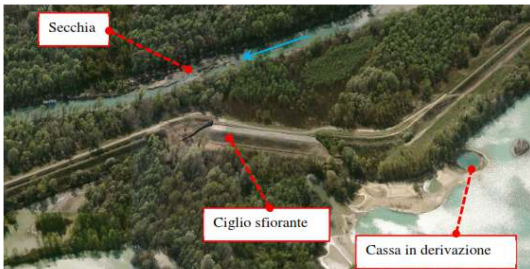
Figura 2.2.3 – Manufatto di immissione nell'invaso laterale (fonte PFTE).
