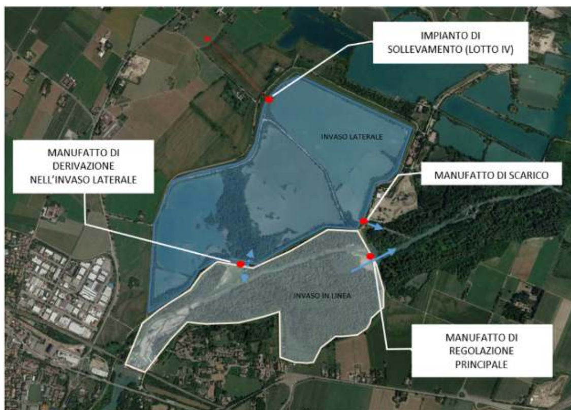
Figura 3.1.2 – Planimetria con ubicazione apparati di derivazione e scarico (fonte PFTE).
