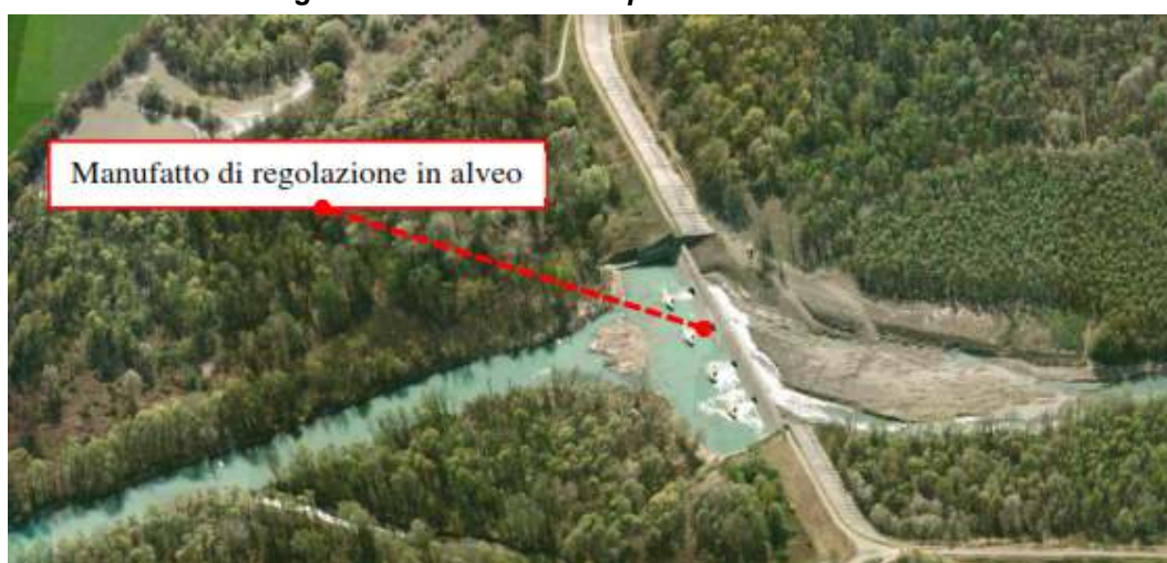
Figura 2.2.2 – Traversa di regolazione (fonte PFTE).
