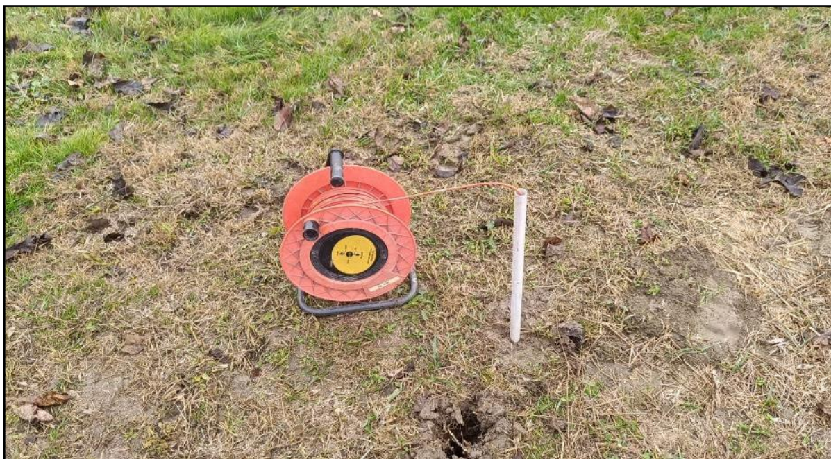
Figura 6.35. Installazione piezometro temporaneo
