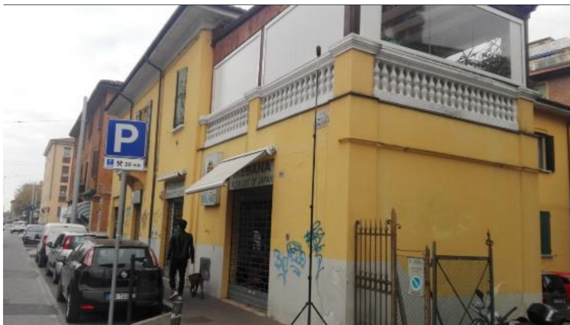
Figura 5-3 – Esempio posizionamento fonometro
