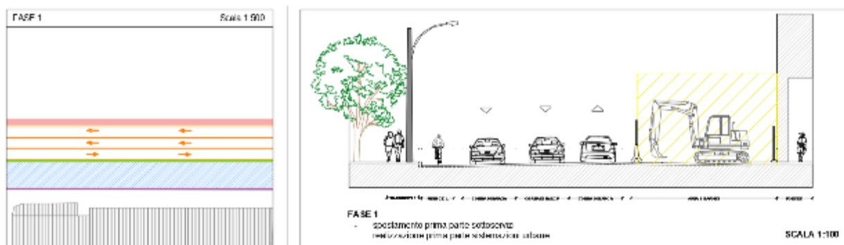
Figura 2-8 – Tipologico cantiere con sede centrale Fase 1
