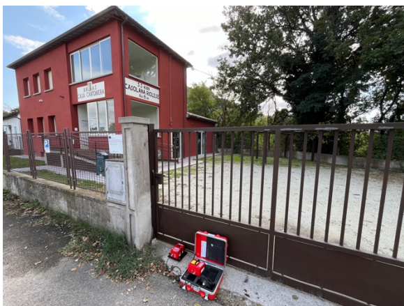
Figura 8. Il sismografo MR3000 installato nella stazione SV1.
