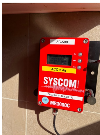
Figura 9. Il sismografo MR3000 installato nella stazione SV2.
