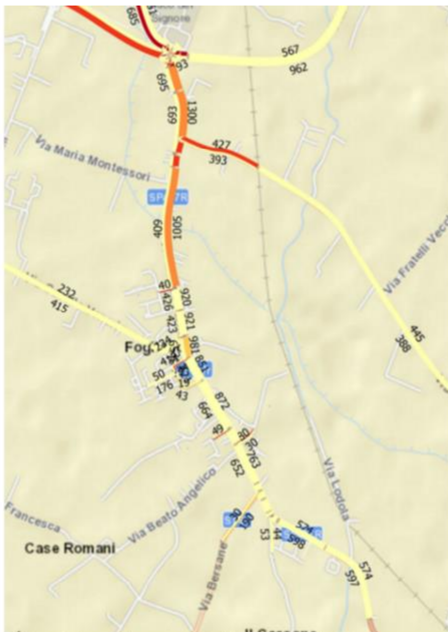
Stato di fatto – Flussogramma dell'ora di punta del mattino riportante i flussi veicolari (etichette) e il grado di congestione (colore)
