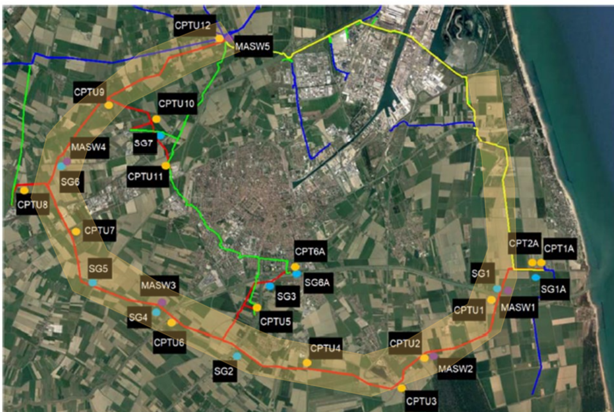
Figura 4-6 - Localizzazione delle indagini svolte nell'ambito della progettazione del Metanodotto "Ravenna Terra-Ravenna Mare DN 300 (12") DN 650 (26") e opere connesse" (Azzurro: sondaggi; giallo: prove penetrometriche; viola: prove MASW) – nel retino in giallo l'area interessata dal Met. Collegamento PDE FSRU di Ravenna al Nodo di Ravenna DN 900 (36"), DP 75 bar.
