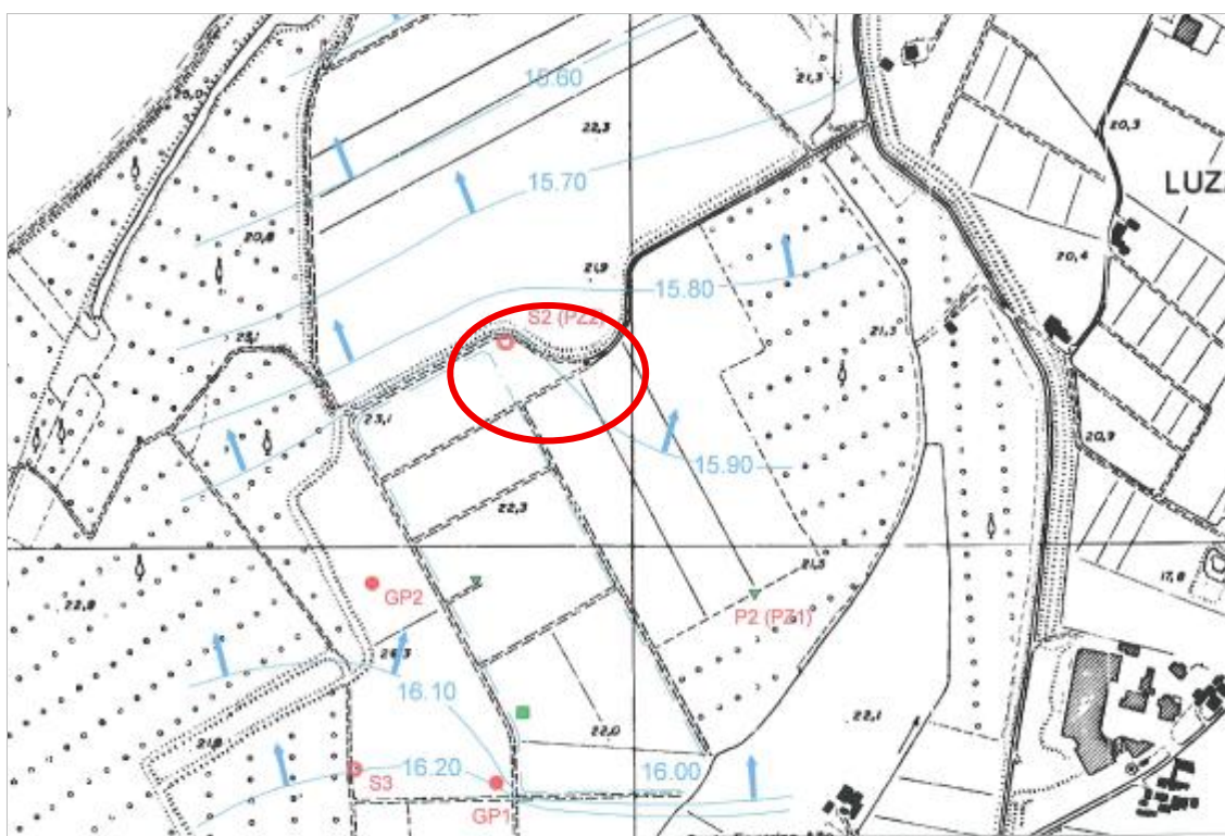
Figura 25: Isopieze estate 2006 (Fonte: Fascicolo 5-Relazione geologica-Sottozona E Polo PO015)
