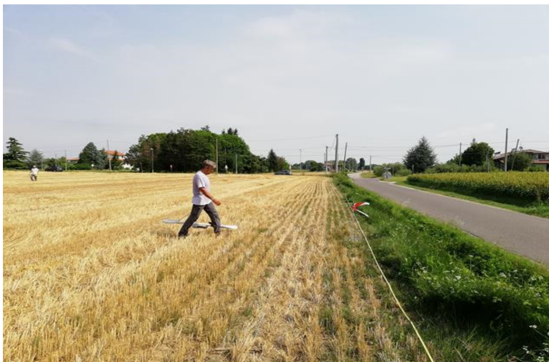
Rilievo con elettromagnetometro – Tratto prima del Picchetto 7
