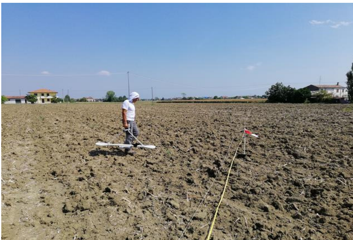
Rilievo con elettromagnetometro – Tratto prima del Picchetto 13
