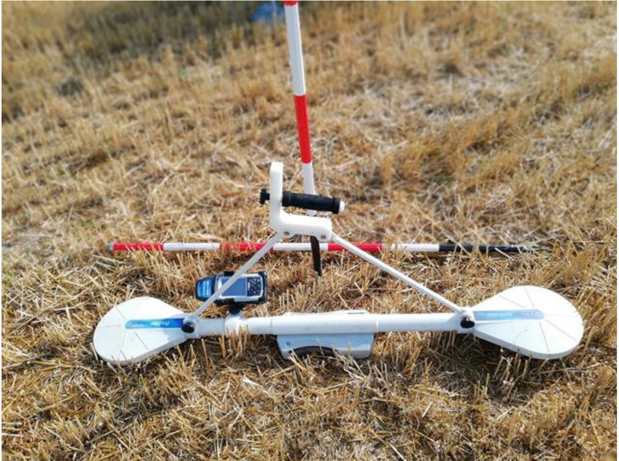
Elettromagnetometro GSSI PROFILER EMP-400 Multi-Frequency EM provvisto di modulo per posizionamento GPS
