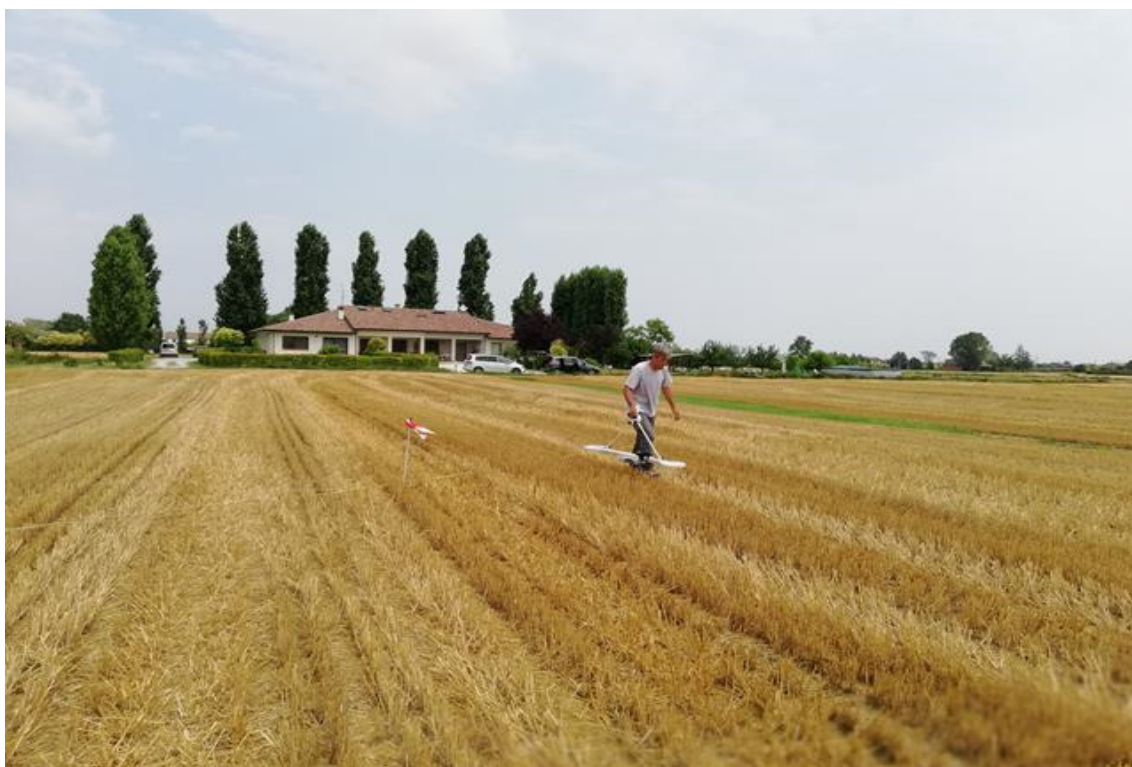
Rilievo con elettromagnetometro – Tratto dopo il Picchetto 9
