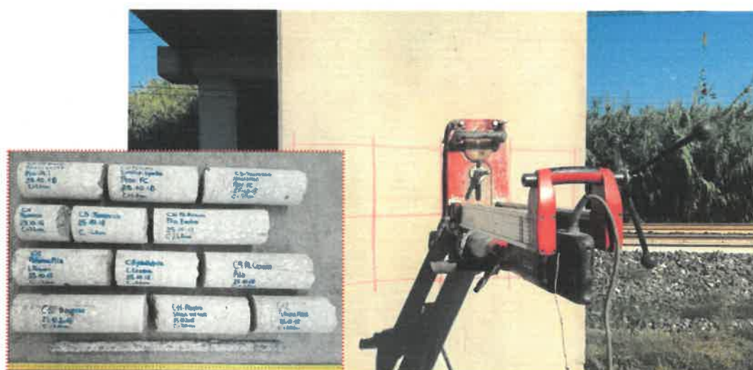
Fotografia durante la fase di prelievo di una carota e particolare del materiale prelevato.
