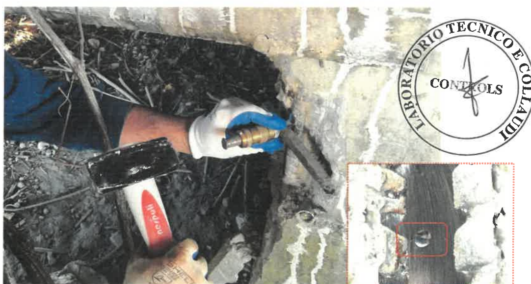
Fotografia durante l'esecuzione della prova POLDI e relativa impronta rilasciata.
