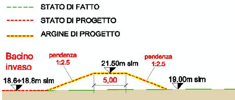
Figura 4 - Schema tipologico del nuovo argine perimetrale est e parallelo a Strada della Vittoria.
