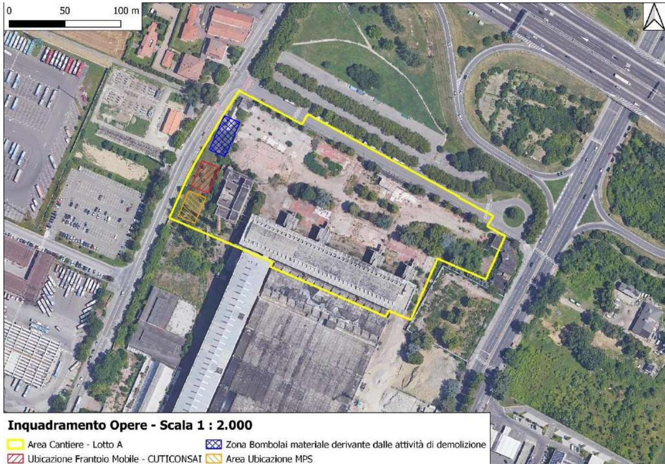
*Figura 6 – Aereo foto con individuazione del Lotto A, della zona di futura ubicazione del rifiuto da costruzione e demolizione da demolire, del frantoio mobile e del materiale trattato con cessata qualifica di rifiuto (ex mps-end of waste).*
